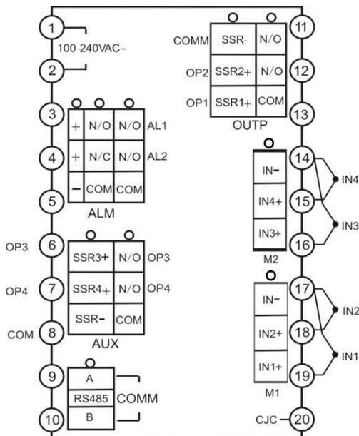
注：F828/F848的输入信号为独立模拟地，各信号之间为不共地输入，也可选择共地端19COM为共(-)输入，目前只支持mV和热电偶信号输入。
